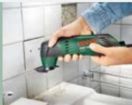
Bosch также предлагает сегментированные пильные диски RIFF для работ в твердых основаниях. С их помощью Вы легко и точно удалите старый порозаполнитель, справитесь с фрезерованием дополнительных кабельных каналов и отрежете мягкую напольную плитку.
