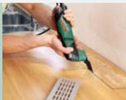
Работайте с комфортом и высокой точностью вблизи пола, стен или кромок предметов. Специальные погружные и сегментированные пильные полотна и диски обеспечат Вам необходимую точность пропилов в древесине, различных металлах и гипсокартоне.
