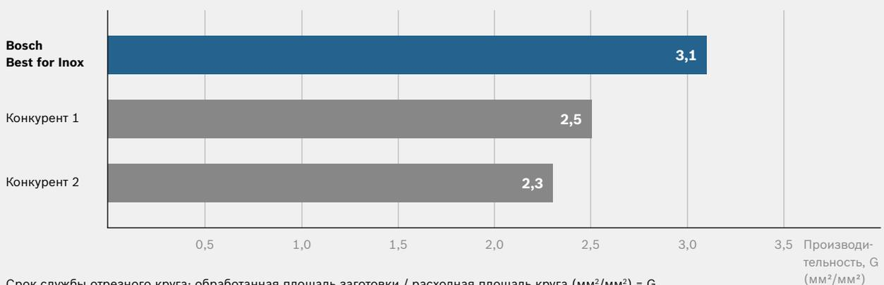
Срок службы отрезного круга: обработанная площадь заготовки / расходная площадь круга (мм²/мм²) = G.
