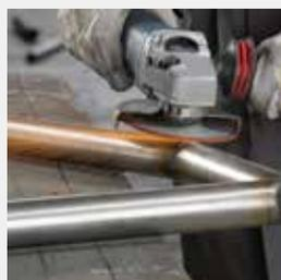
Незначительный нагрев при шлифовании, оптимизированный выброс опилок и небольшое изменение цвета обрабатываемой поверхности благодаря новому рифленому дизайну
