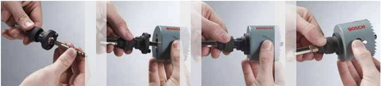
Установка центрирующего сверла
