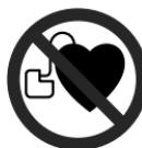
**Не устанавливайте измерительный инструмент вблизи кардиостимуляторов.** Магнит создает поле внутри измерительного инструмента, которое может отрицательно влиять на работу кардиостимулятора.
